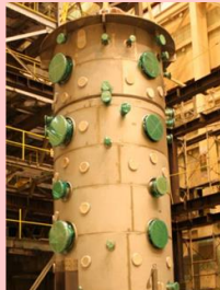
大型格納容器実験装置 (CIGMA)
